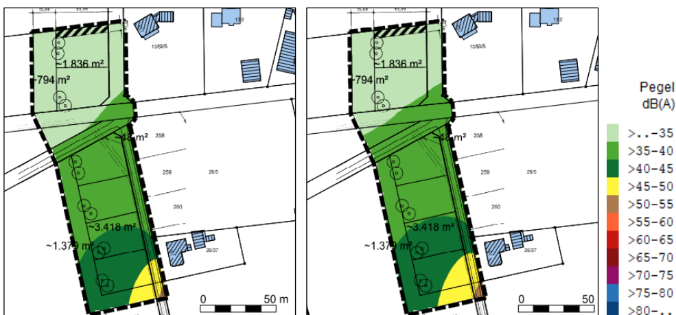
Abbildung 4 Variante 1, Werktag, 8 00 – 20 00 Uhr, links: h = 2\text{ m} (EG), rechts: h = 5\text{ m} (OG)
