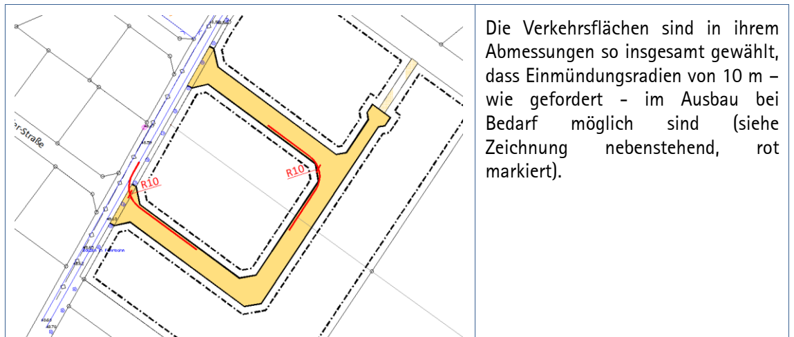
Abb. 15 Ausbauradien von bis zu 10 m sind bei Bedarf möglich
