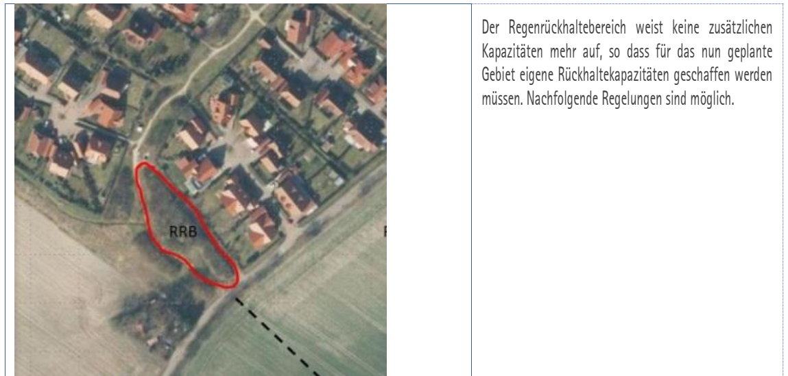
Abb. 22 Geplante Lage der beiden neuen Regenrückhaltebereiche
